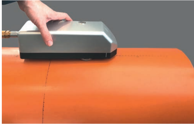
Bild 2. Messaufbau mit Terahertz-FMCW-Handscanner: Messungen im Feld, z.B. an Fernwärmerohren, sind mit dem mobilen Terahertz-Sensor möglich
