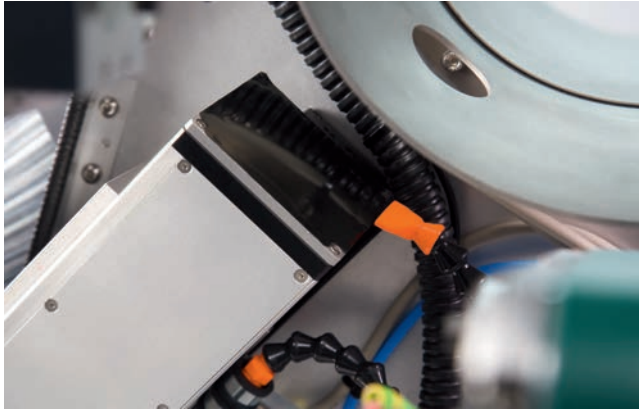
Bild 1. Detailaufnahme eines Terahertz-Sensors mit Spüleinrichtung zur Vermeidung von Wasser- und Staubablagerungen am Sichtfenster (© Fraunhofer ITWM)
